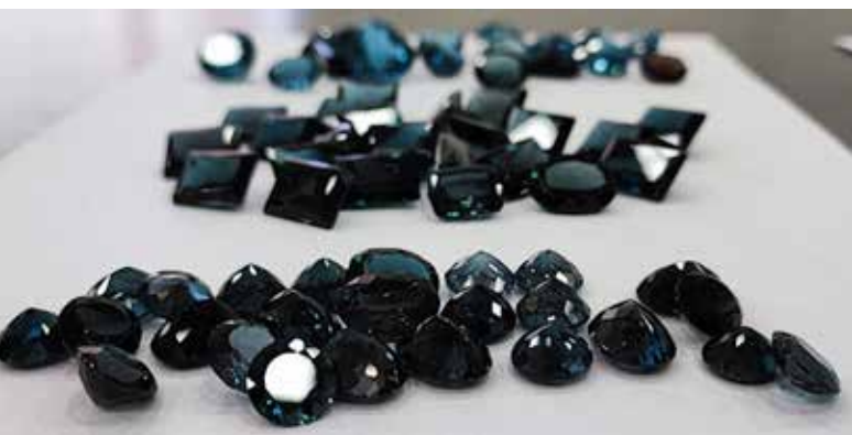
Фото полудрагоценных топазов: - естественной окраски (вверху); - окрашенных облучением на реакторе (внизу)
